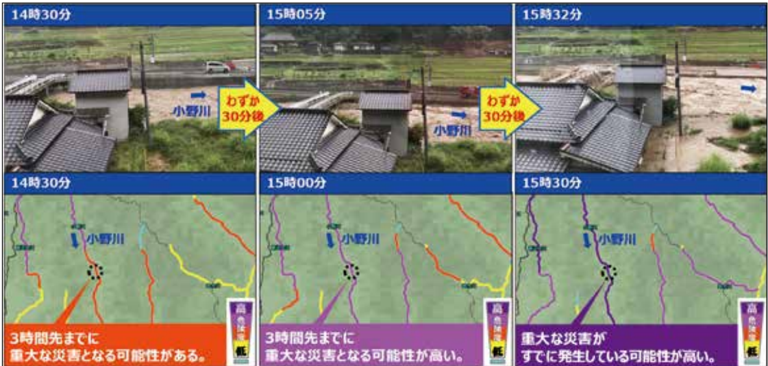
小野川が増水・氾濫する様子（上段）と危険度分布の表示（下段） （写真：日田市職員提供、黒丸は撮影地点）
