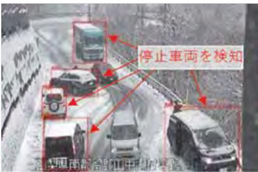
図-8 CCTVカメラを用いた交通障害自動検知システム
