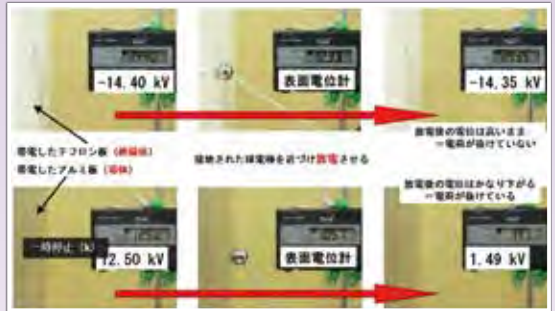
絶縁体(上段)と導体(下段)の放電前後の帯電電位の変化
