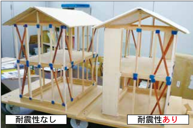
木造住宅の倒壊実験教材「ぶるる」
