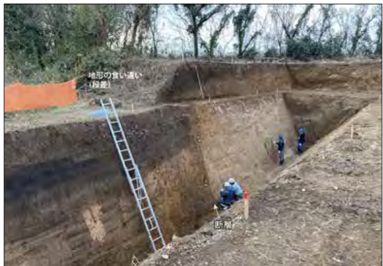
図4 活断層のトレンチ調査。矢印の部分が断層で、断層を挟んで異なる地層が接している。
