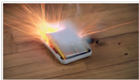
写真3 モバイルバッテリーからの出火イメージ
