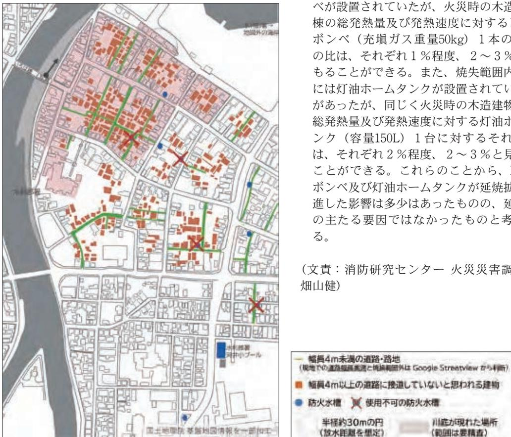
図5 輪島市大規模火災の焼失範囲及びその周辺の市街地の状況と防火水槽
