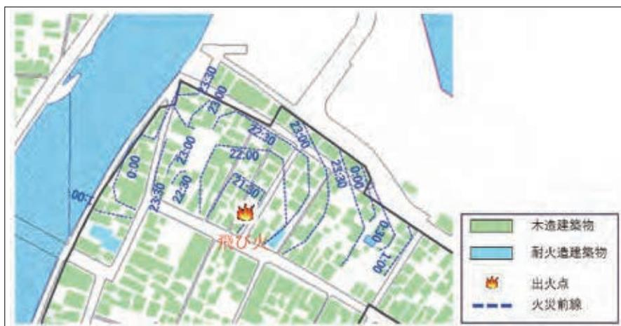
図3 市街地火災延焼シミュレーションから推定された北側街区の延焼動態
